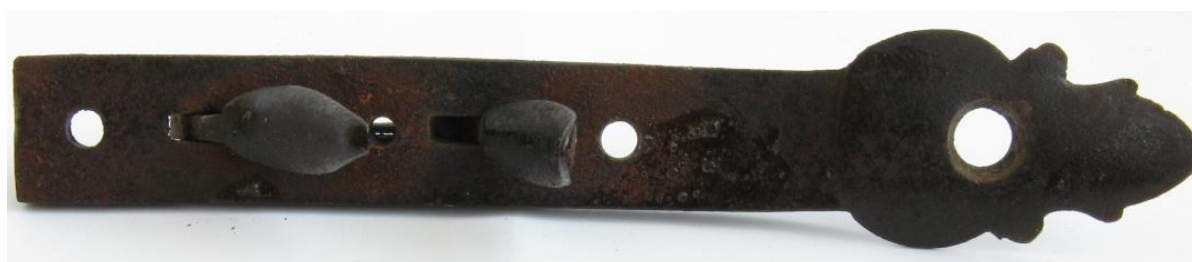
Obr.: Spoušť s napínáčkem je uchycena k pažbě pouze jedním vrutem
