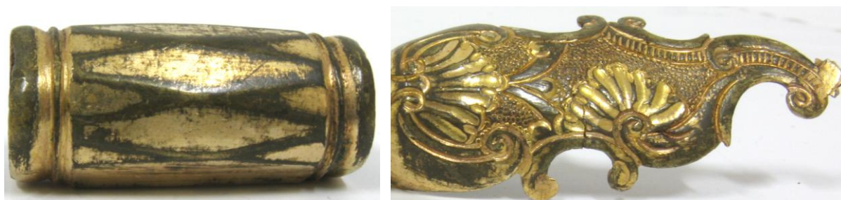
Obr.: Tmavé oxidační vrstvy na základním kovu, kde se nedochovalo zlacení
