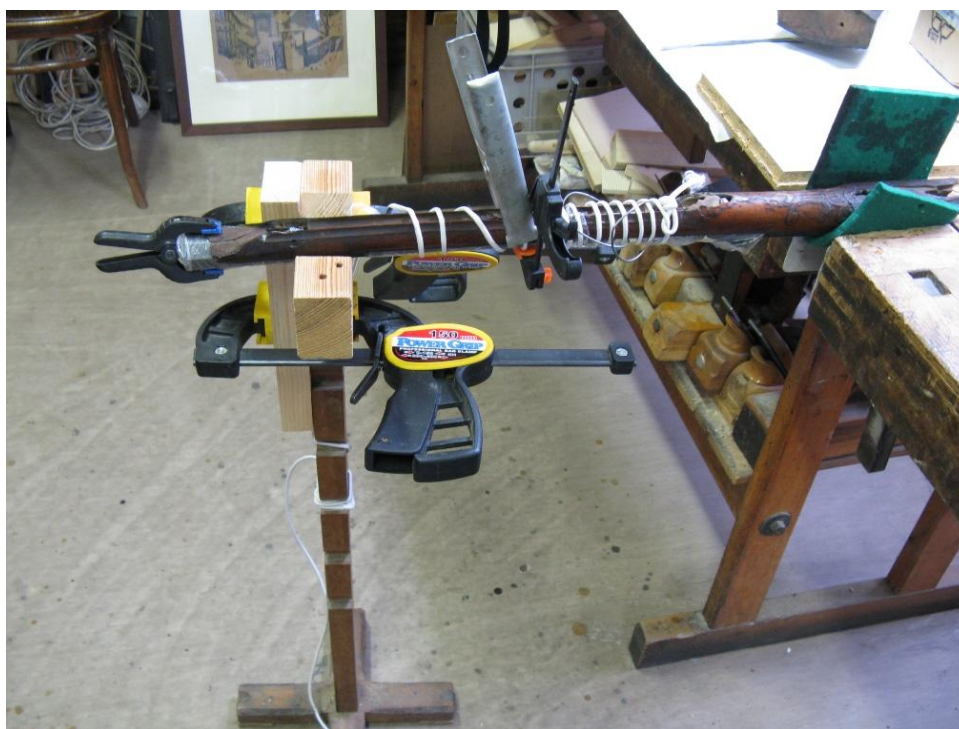
Obr.: Klížení prasklin
