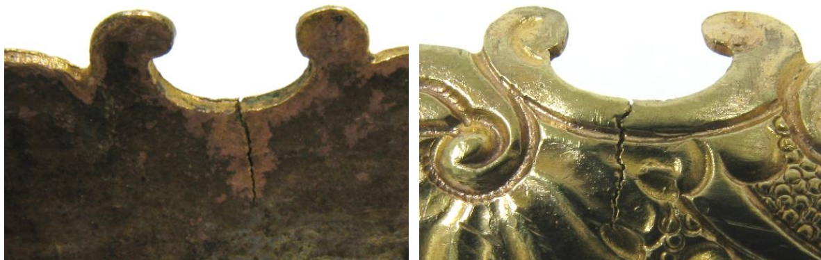
Obr.: Pohled na prasklinu ze spodní strany a shora
