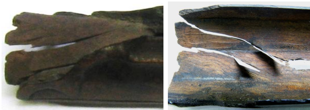
Obr.: Pohled na konec pažby po demontáži kovových částí – ze spodní strany a shora
