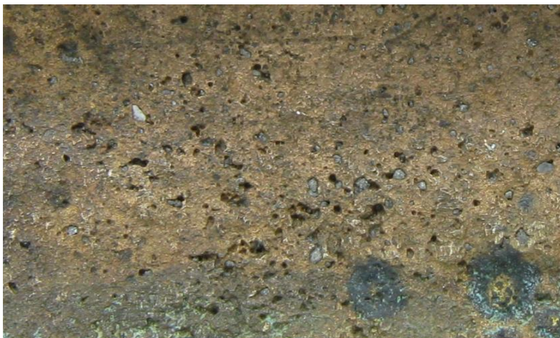
Obr.: Detail pórovitosti povrchu odlitku z nepohledové strany
