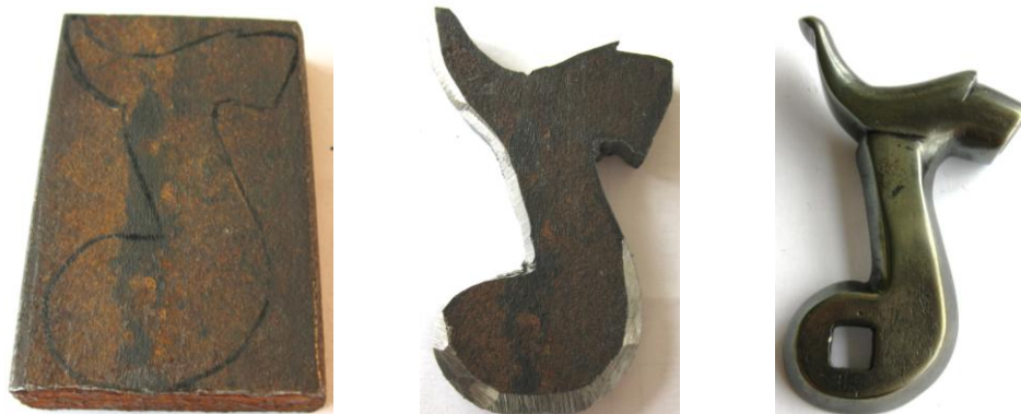
Obr.: Výroba kohoutu
