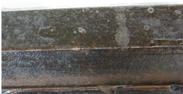
Obr.: Narušená vrstva laku
