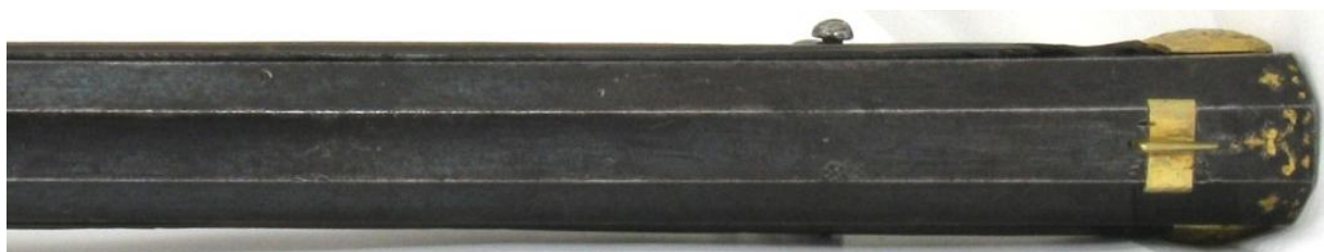
Obr.: Hlaveň po zalakování povrchu a zpětné montáži mušky a hledí
