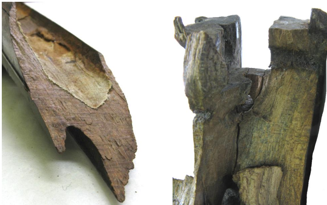
Obr.: Detail některých očištěných ploch před klížením
