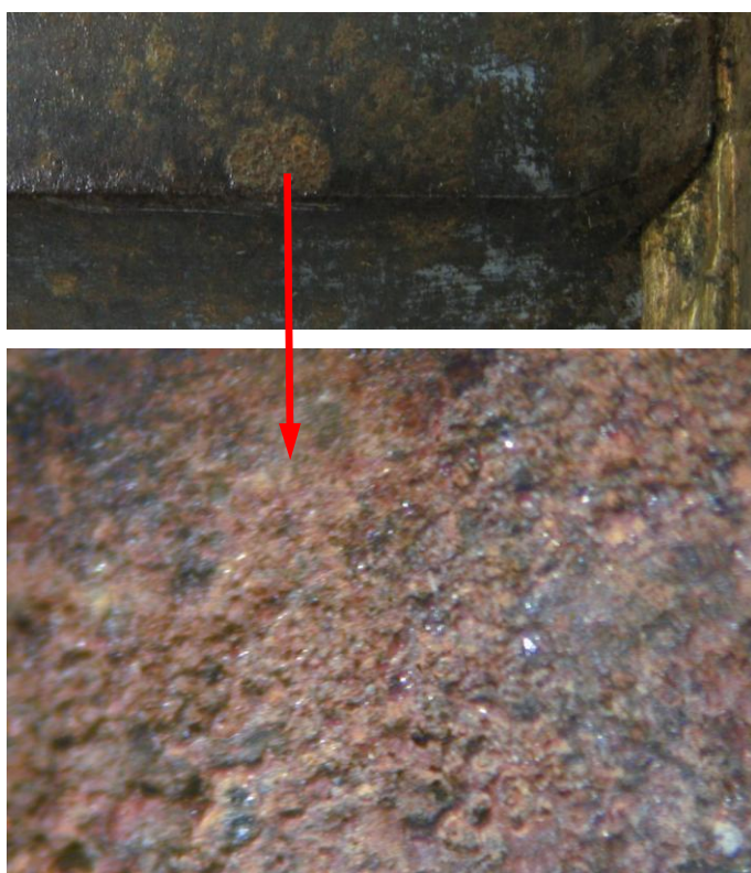
Obr.: Mikroskopický snímek korozních produktů železa při 40x zvětšení – hloubková koroze
