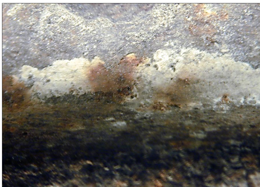
Obr. 6.1 Mikrosnímek bílých nečistot napojených na korozní produkty
