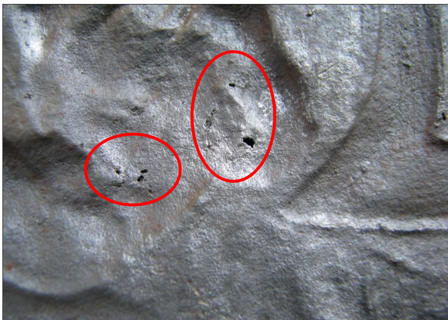
Obr. 21 Detailní pohled na dutiny v odlitku
