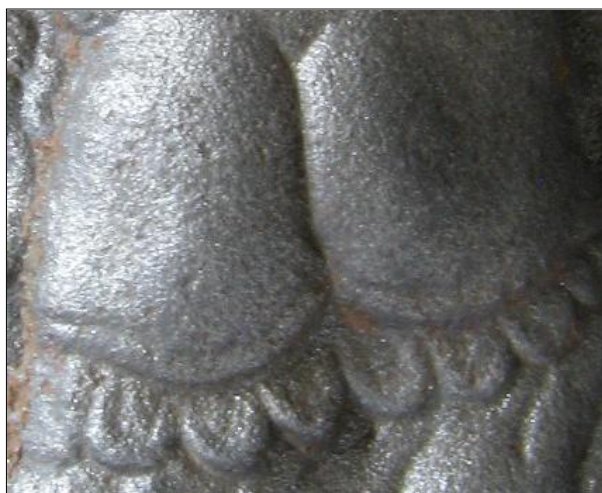
Obr. 18.1 Detailní pohled na část předmětu během odstraňování korozních produktů otryskáváním
