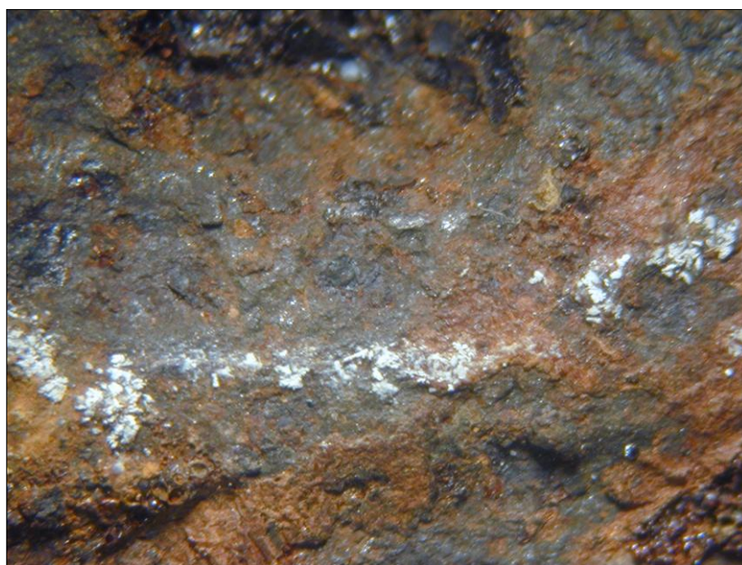
Obr. 11.1 Mikroskopický snímek detailů korozních produktů na povrchu předmětu
