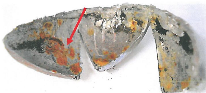
Obr. 57 Pod pokličkami jsou skvrny připomínající korozní produkty železa. Je možné, že byly mezi dřevěnými třískami přimíchány kousíčky železných pilin. A právě ty, mohou způsobovat tyto korozní stopy
