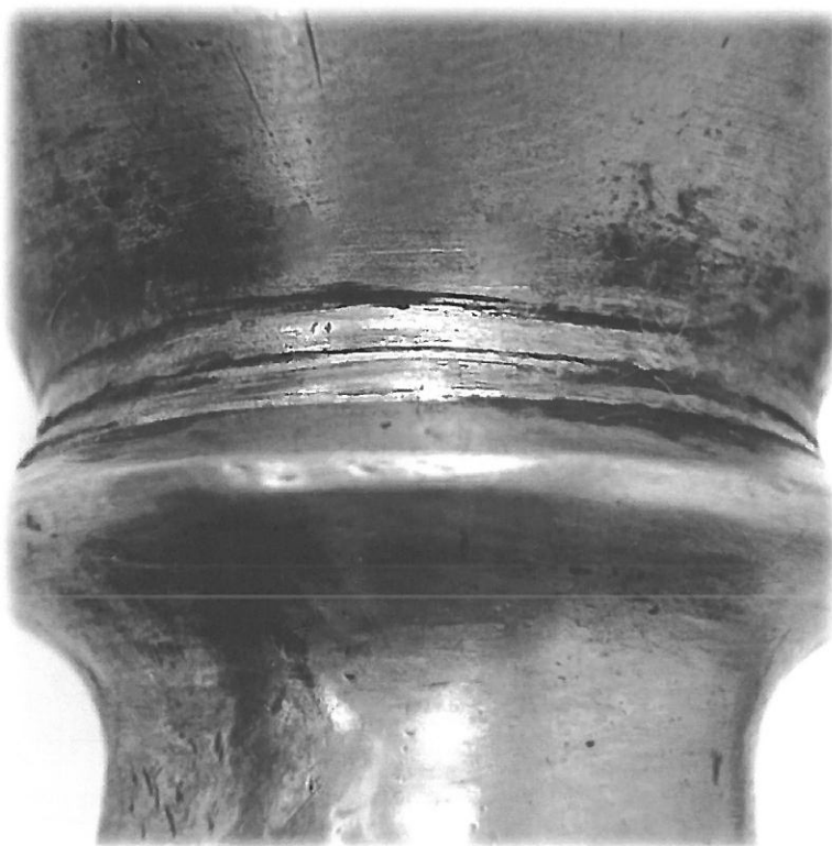
Stav jediné podélné praskliny na dříku po restaurování
