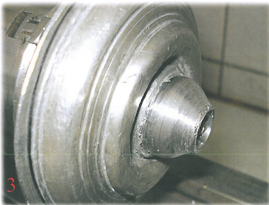
Obr. 92 Vysoustružený tvar pro další opracování
