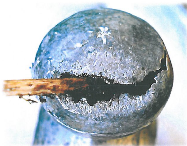
Obr. 65 Dřevěné jádro lze snadno odstraňovat pomocí špejle
