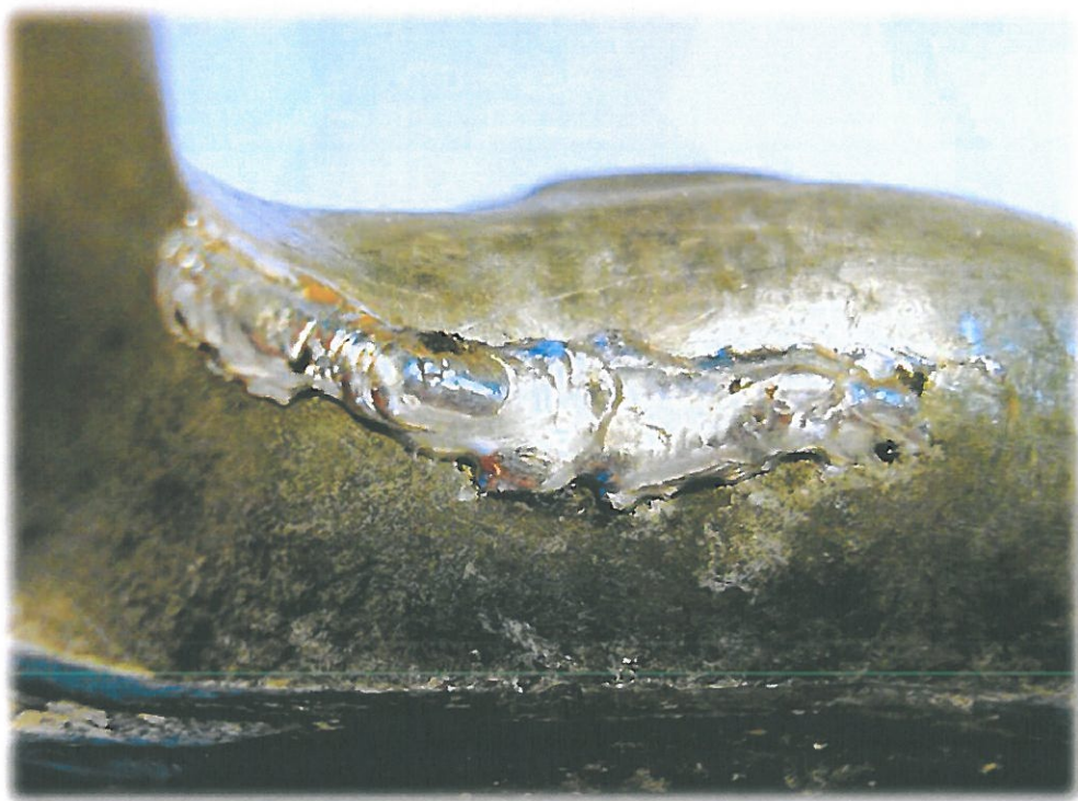
Obr. 80 Čerstvě zapájené místo
