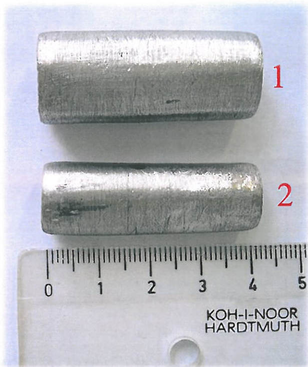
Obr. 87 Měřítka délky obou výztuží
