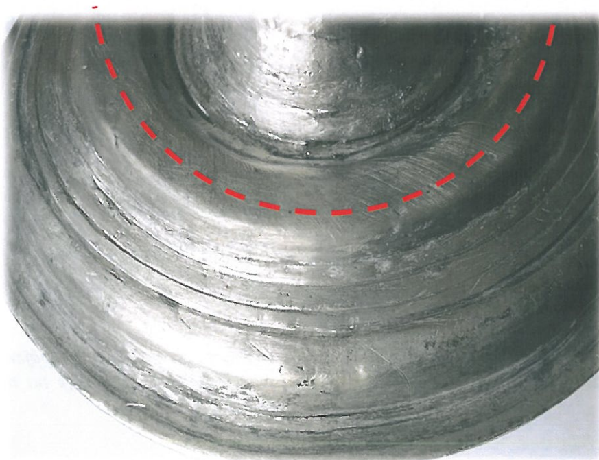
Obr. 42 Zapájená prasklina ve spodní části misky (slitina s vyšším obsahem olova 60 %). I když je zde aplikována odlišná slitina, oprava je provedena správně – oba materiály jsou dostatečně propájeny a místo je pečlivě opracováno
