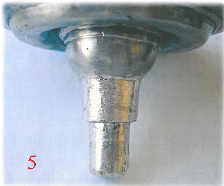
Obr. č. 94 Na výztuž byl připájen kroužek z 2 mm silného plechu. Detail již opilovaného místa
