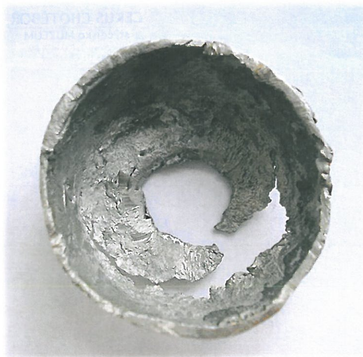
Nožička č. 2 Vlivem užívání je zde značný úbytek materiálu
