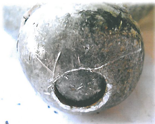
Obr. 69 Půlkulička po demontáži od vnitřní výztuže
