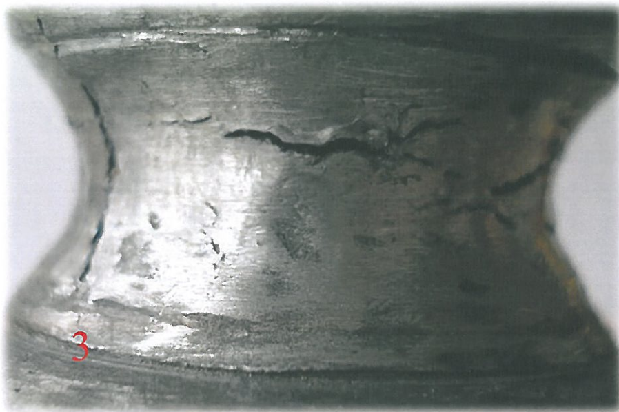
Obr. 28 Prasklina ve spodní části dříku
