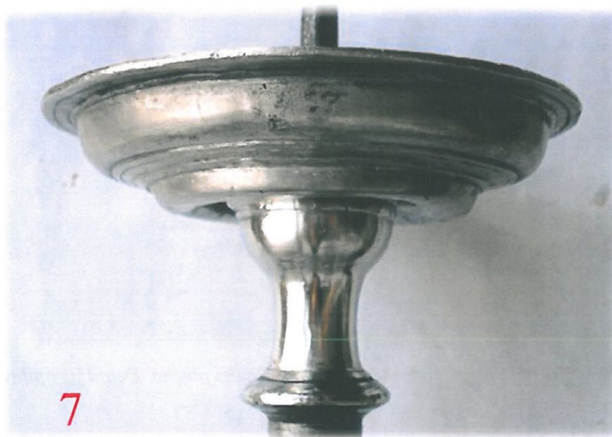
Obr. č. 96 Vyhlazení vyleštěnými ocelovými čákany
