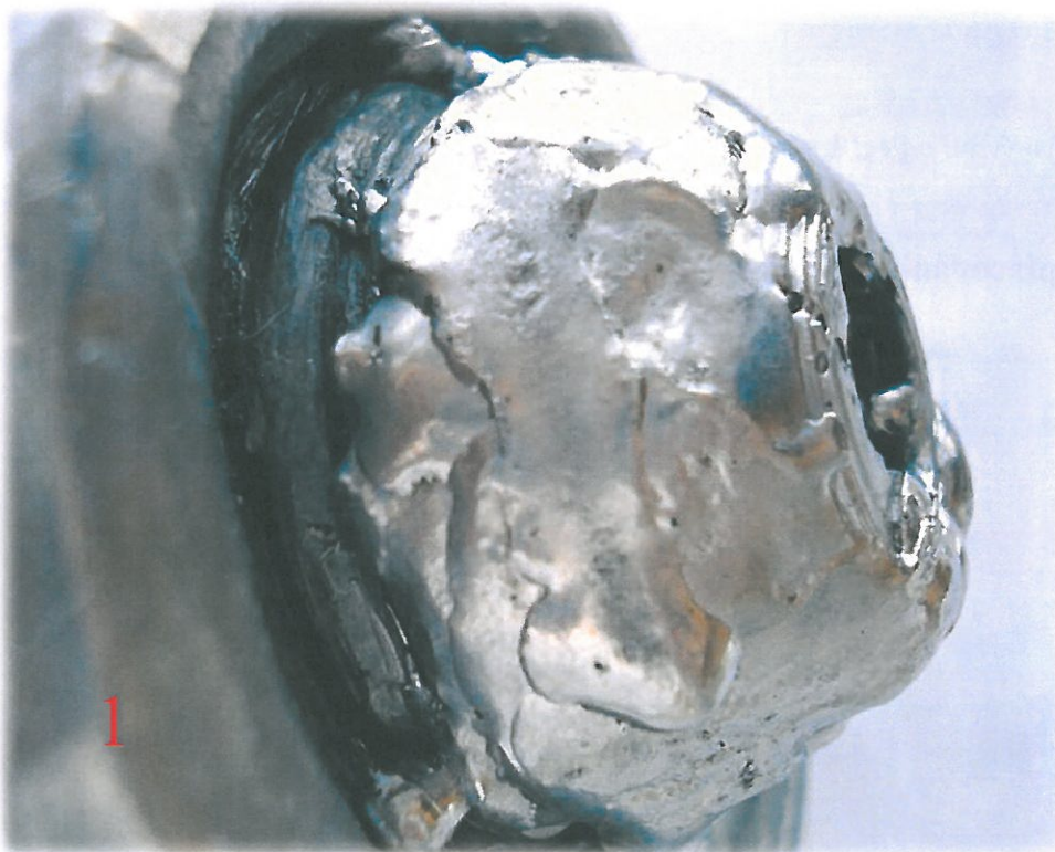
Obr. 90 Prvním krokem bylo doplnit materiál
