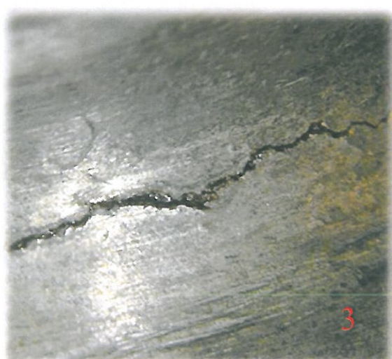
Obr. 22 a Obr. 23 Mikrosnímky prasklin (v spodní části dříku)
