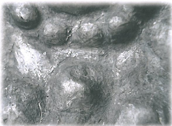
Obr. 12 Snímek oxidační vrstvy
