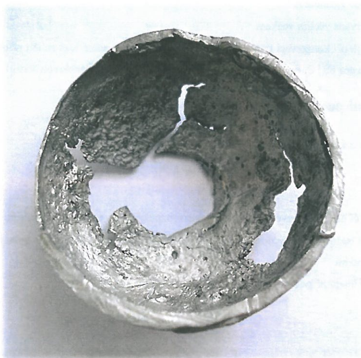
Nožička č. 1 Ve většině míst není síla materiálu dostatečná
