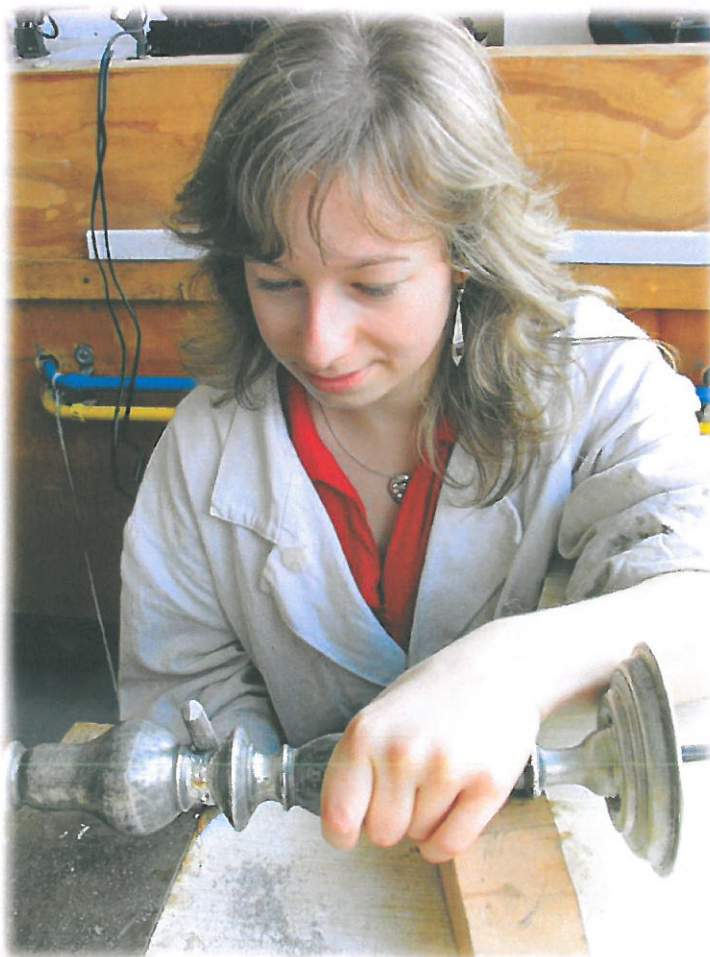
Obr. 102 Pilování přebytečného materiálu
