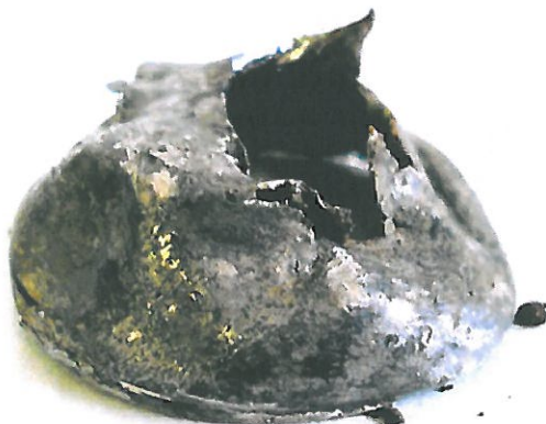
Obr. 63 Vrchní část nožičky č. 1 po demontáži (nebylo možné jinak pokličku demontovat, než ostrým nožikem)
