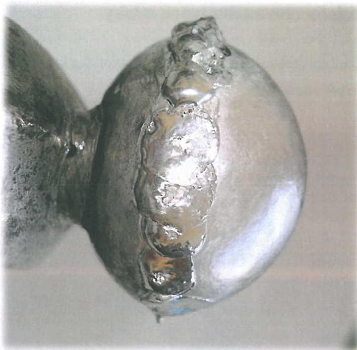
Detail čerstvě zapájeného místa
