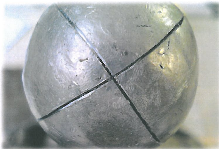
Obr. 55 Naříznutí cínových pokliček - lupenkovou pilkou
